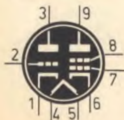
6HF8 TRIODO-PENTODO CONVERTITORE (zoccolo noval)
