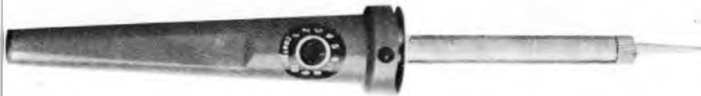
Figura 3. Per ottenere il meglio nei montaggi è indispensabile un buon saldatore con la punta sempre pulitissima.
