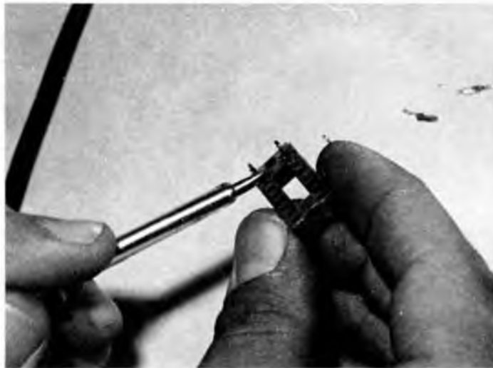
Collocazione dei pin nello zocchetto. Nelle foto alcuni modelli di saldatore idonei.
