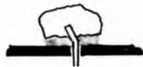
Saldatura sollevata della pista di rame.
