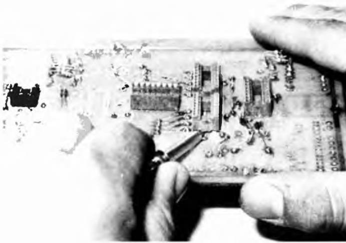
L'impiego del saldatore nella rimozione degli zocchetti sul circuito stampato.
