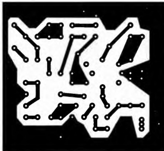
A sinistra, disposizione dei componenti sulla basetta; in alto, riproduzione in dimensioni naturali della traccia necessaria per l'esecuzione del circuito stampato.
