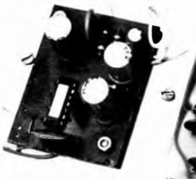
Schema elettrico e basetta dell'amplificatore di bassa frequenza utilizzato per il cercametalli.
