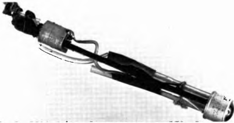
Interno della sonda del fototachimetro; il buon funzionamento dello strumento dipende dalla realizzazione di essa, quindi si osservino attentamente tutti i piccoli particolari. A destra, spaccato grafico della sonda. A, fototransistor; B, piastrina in bachelite; C, cavo schermato; N, nastratura; E, fissacavo. Tutte le misure sono in millimetri.
