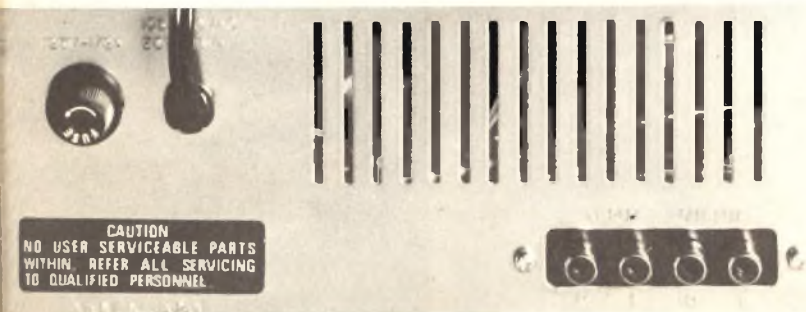
Sul retro del contenitore del Lafayette RK-890A sono sistemate le prese per applicare il segnale ad un amplificatore e per i microfoni, uno per canale.
