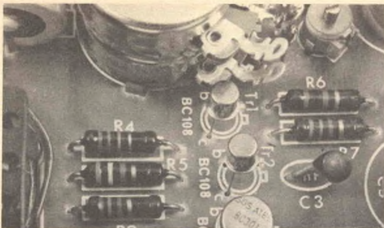
Particolare della basetta in cui sono evidenziati i semiconduttori TR1 e TR2, entrambi di tipo BC 108.
