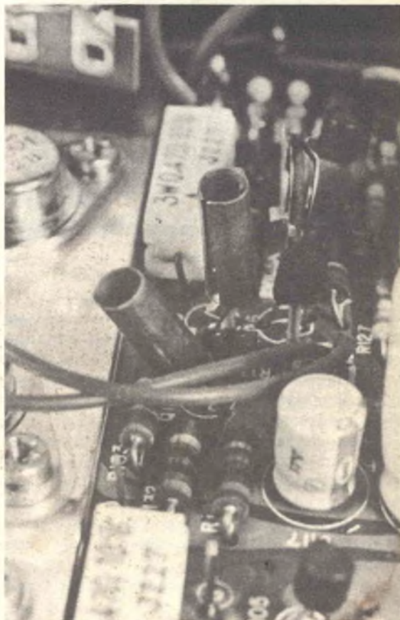
Per una eventuale riparazione l'identificazione dei componenti è semplicissima. Sullo stampato è riportata serigraficamente la sigla di ogni pezzo.
