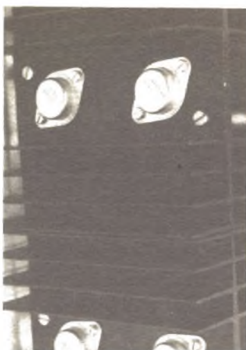
Alette di raffreddamento e transistor finali 2N3055.
