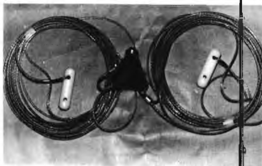
DIPOLO per i 45 m già tarato apertura totale 22 m può essere montato a V oppure orizzontalmente occupa pochissimo spazio prezzo L. 45.000
