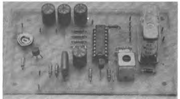
Figura 2 - Circuito elettrico di alimentazione per il funzionamento a 14 V.
