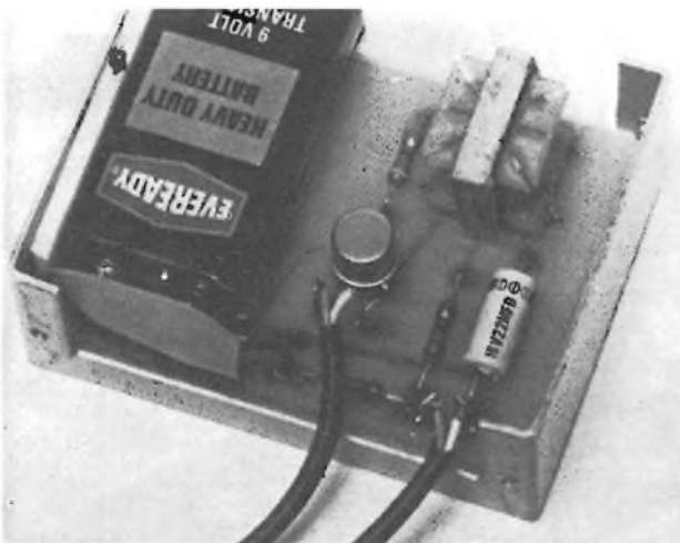
Figura 9 - Metodo di installazione dell'intero dispositivo e del « flash » all'interno di un contenitore a tenuta stagna.
