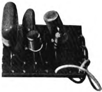
Figura 6 - Fotografia della piastrina di supporto completamente montata: i pochi componenti fissati su questa piastrina semplificano enormemente la tecnica di cablaggio.
