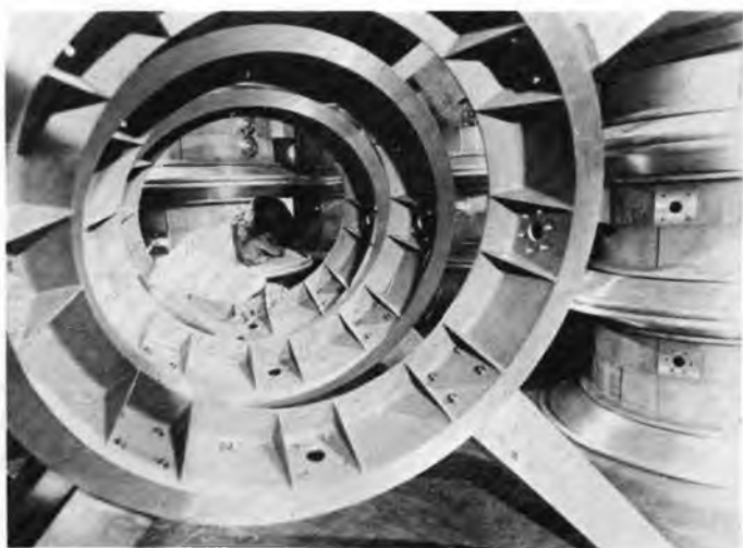
Un addetto della «GTE Sylvania Incorporated» controlla dei pezzi lusi ad anello, lavorati con precisione, usati in sistemi ad antenna parabolica. Ogni pezzo è unito ad un piedestallo e sostiene un riflettore parabolico (a forma di piatto) del diametro di 10 piedi, che serve a concentrare in un raggio il potere irradiato. Questi sistemi ad antenna, in produzione presso la «Western Division» dell'azienda a Mountain View, California, saranno usati per la difesa elettronica in campo militare.
