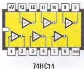
Fig.3 Connessioni dell'Integrato 74HC14 viste dall'alto e con la tacca di riferimento rivolta verso sinistra, dei transistor BC547 e ZTX653 viste da sotto, e vista fronte e retro delle connessioni del diodo led da 1 Watt per SMD (codice =DL4.1). I terminali A e K sono caratterizzati da una diversa smussatura.
