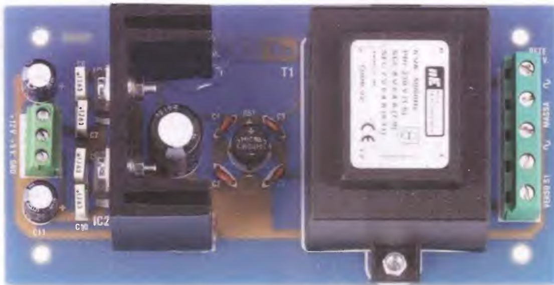
Fig.10 Sopra la foto dello stadio di alimentazione come si presenta a montaggio ultimato e sotto il disegno pratico dell'alimentatore. Si vedono anche i cablaggi all'interruttore S1 e alla vaschetta di rete e le alimentazioni per i due circuiti LX.1778 e LX.1778B.
