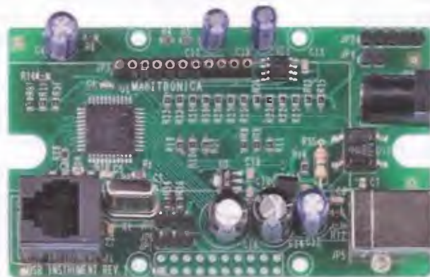
Fig.3 Foto della scheda dell'interfaccia USB che forniamo già montata con componenti SMD e collaudata.
