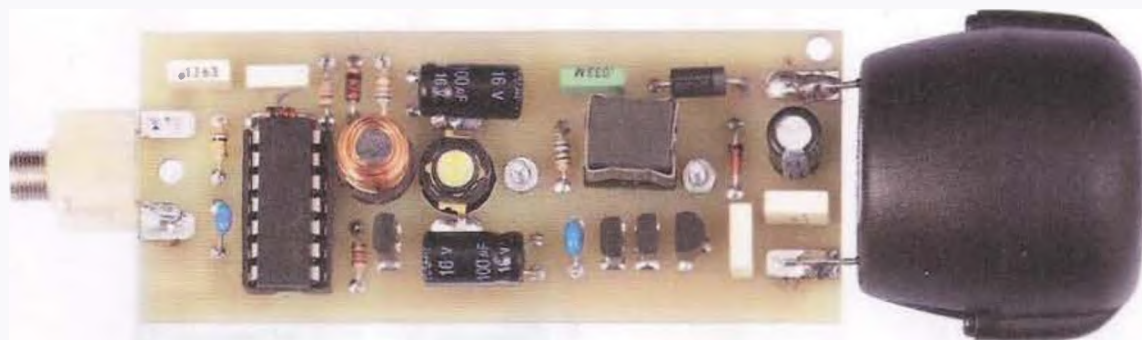
Fig.7 In questa foto è riprodotto il circuito della sirena a montaggio ultimato. Questo esemplare è stato utilizzato nel corso dei nostri test.
