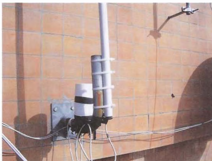
Fig.6 Ecco come abbiamo risolto il problema del fissaggio del tubo contenente l'amplificatore.
