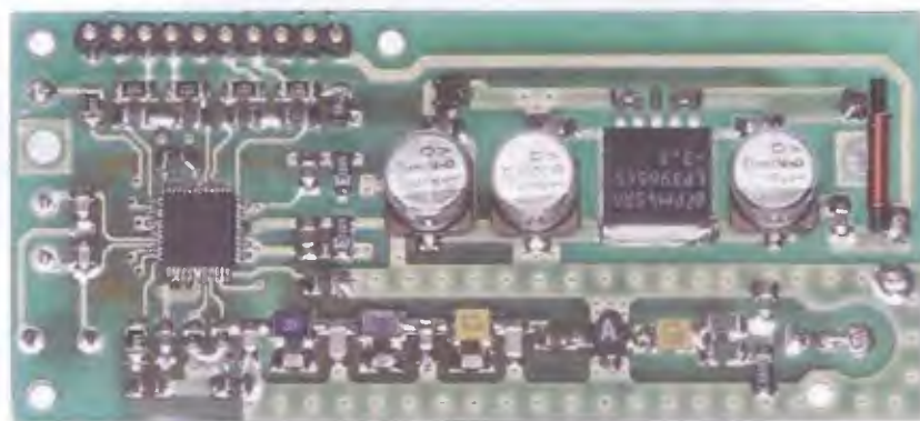
Fig.17 Il circuito in SMD KM1644 che forniamo già montato e testato nel nostro laboratorio, è visto in questa foto dal lato componenti.
