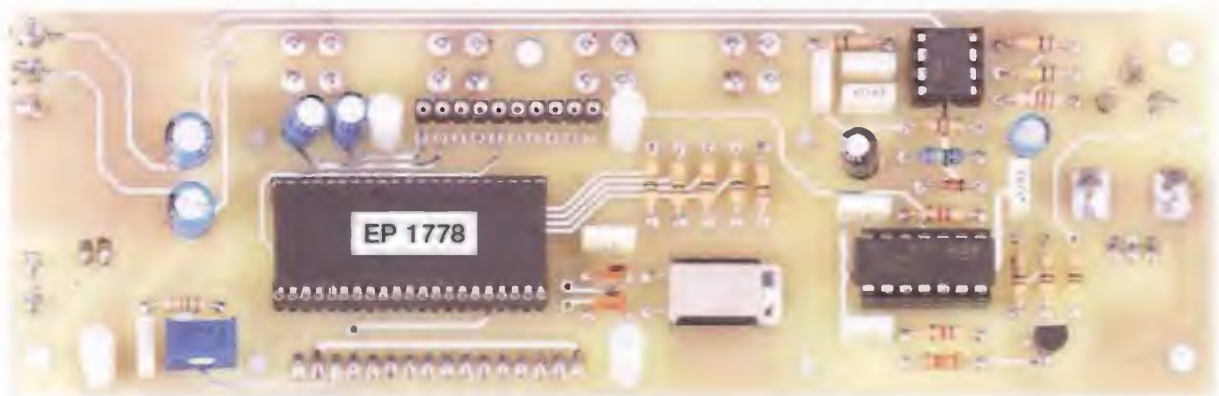
Fig.16 Foto dello stadio CPU siglato LX.1778 visto dal lato componenti sul quale andrà innestata la scheda in SMD siglata KM1644 (vedi figg.17-18). Dal lato opposto andranno invece montati il display LCD, i quattro pulsanti, la manopola ed il diodo led come evidenziato in fig.21.
