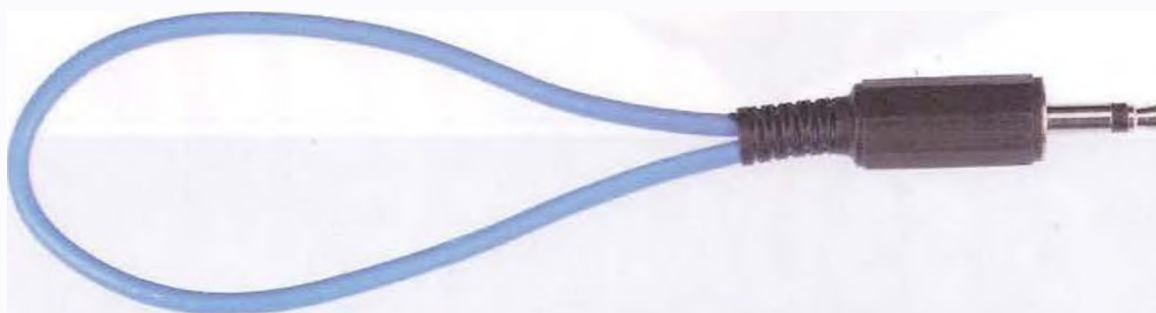
Fig.10 Fissando un cordoncino all'interno dello spinotto jack, basterà tirarlo a strappo per attivare la sirena e accendere il diodo flash.
