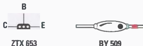
Fig.2 Connessioni dei transistor ZTX653 viste da sotto e del diodo ad alta tensione BY509. Per individuare il terminale + di tale diodo vi rimandiamo alla fig.4.
