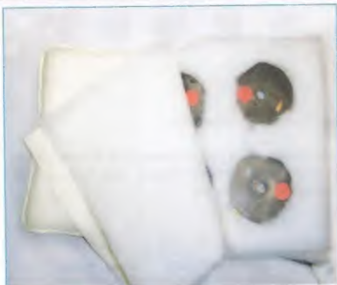
Fig.1 Il nuovo panno diffusore per magnetoterapia a bassa frequenza è composto da 6 solenoidi che consentono di distribuire uniformemente il campo magnetico su una zona più ampia.
