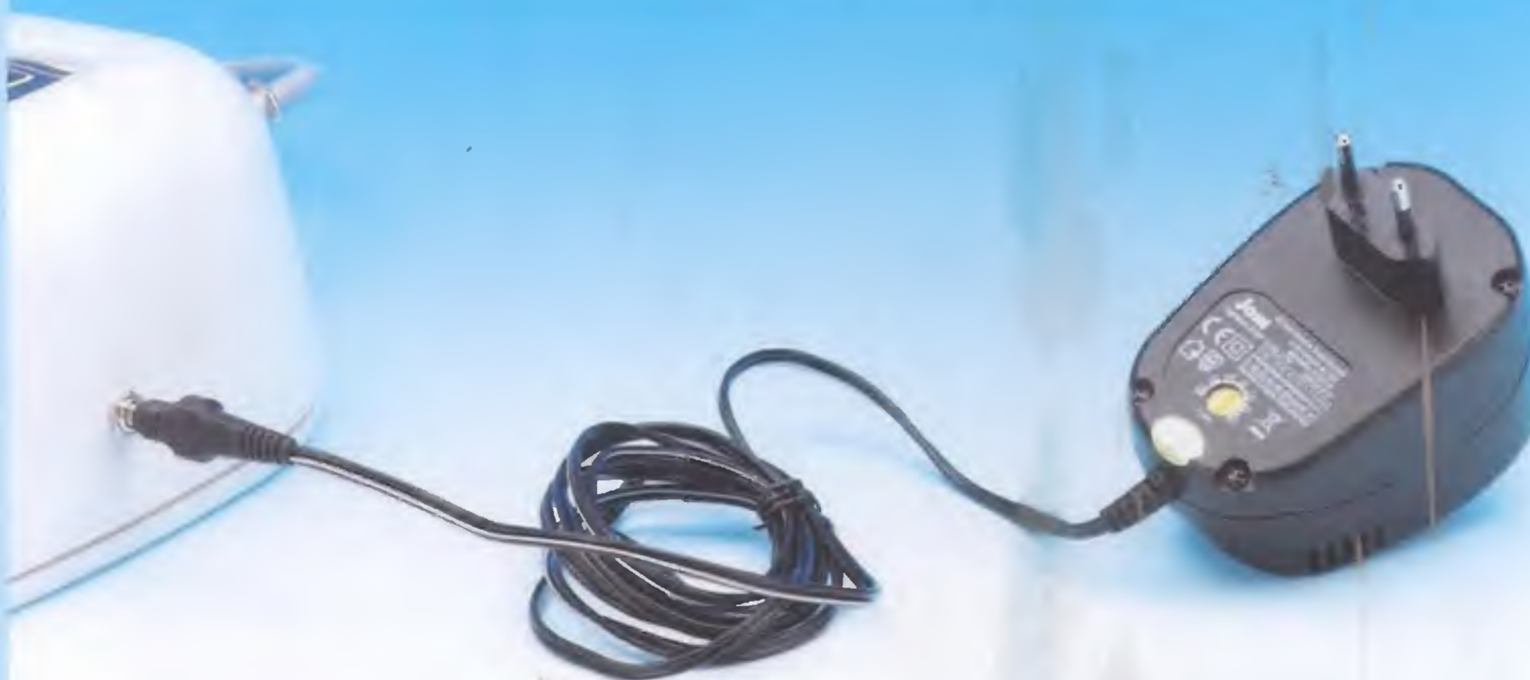
Fig.21 In questa foto è visibile il collegamento dell'alimentatore esterno alla consolle dello shiatsu-chrome. Ricordate, prima di collegare l'alimentatore, di selezionare il valore di 6 Volt della tensione di uscita tramite l'apposito selettore rotante e di scegliere la corretta polarità mediante l'apposito spinotto, che dovrà essere il 5.5x 2.1 come stampigliato sul suo corpo.
