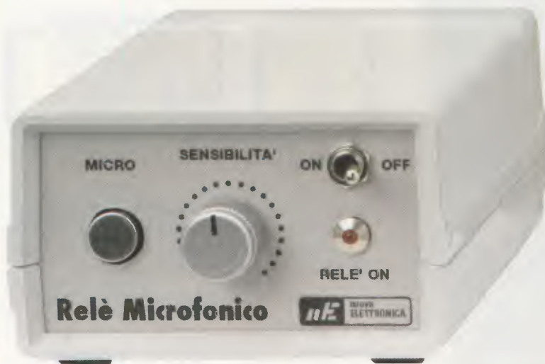
Fig.9 Sul pannello frontale del mobile sono visibili il microfono, la manopola della sensibilità, la gemma del diodo led e il deviatore di accensione S1.
