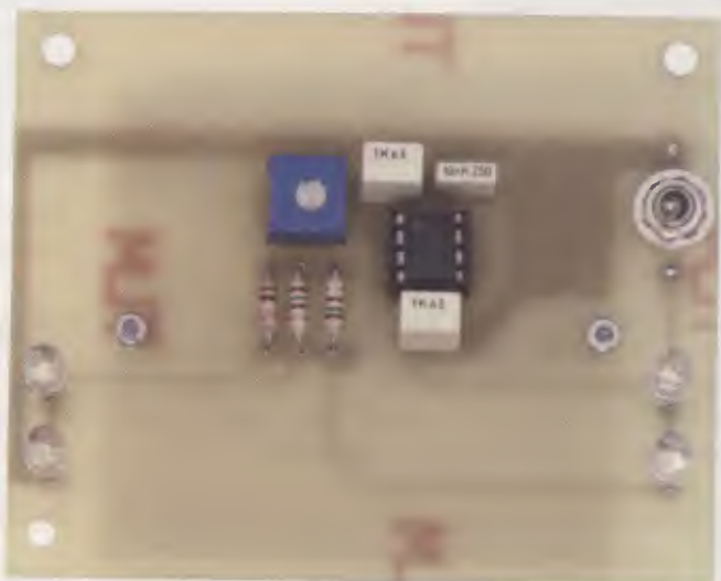
Fig.6 A destra la foto del lampeggiatore con 4 diodi led tipo Flash, che potrete collocare sotto la sella della bicicletta fissandolo con due fascette in plastica.
