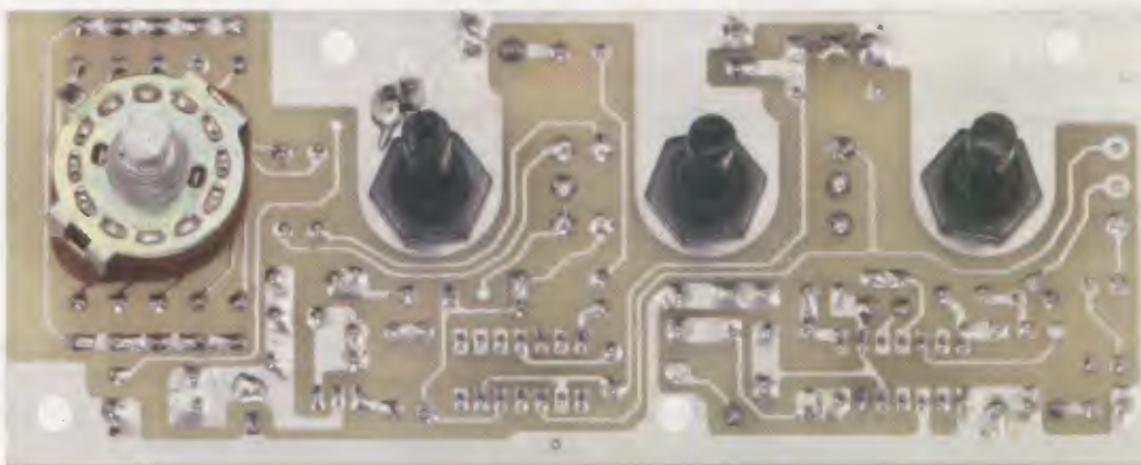
Fig.7 Prima di fissare il commutatore e i tre potenziometri sul circuito stampato, consigliamo di accorciarne i perni (vedi figura in alto), perchè ad eseguire questa operazione quando questi risultano già fissati sul circuito stampato si corre il rischio di danneggiare qualche componente. Per eseguire delle saldature perfette, vi raccomandiamo come sempre di mantenere la punta del saldatore pulita e di usare poco stagno.
