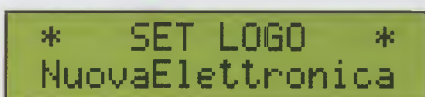
Fig.40 Per scrivere la parola da visualizzare premete il tasto Sel e i tasti > <.
