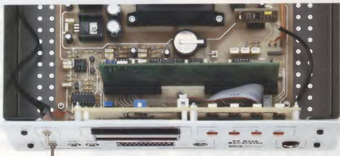
Fig.19 In questa foto potete vedere il circuito stampato KM.1631 in SMD (vedi fig.15) già innestato nei due connettori femmina CONN.5 ed anche il circuito stampato del Display e dei Pulsanti LX.1630/B già bloccato sulla mascherina frontale del mobile.
