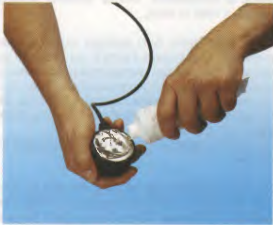
Fig.22 Prima dell'uso il diffusore deve sempre essere cosparso uniformemente con uno strato di gel conduttore di circa 1 mm di spessore. Non dimenticate di effettuare questa operazione, altrimenti rischiereste di danneggiare il diffusore e di provarvi delle bruciature.
