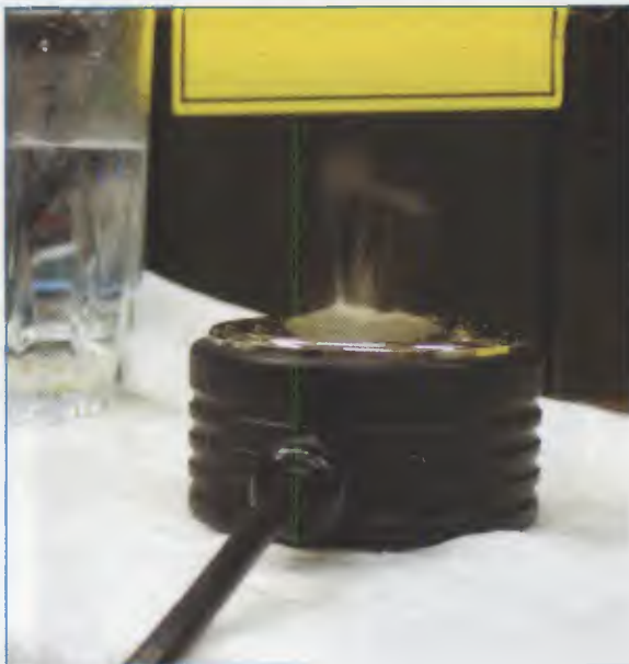
Fig.21 Per verificare il corretto funzionamento del diffusore, a generatore spento posate sul diffusore alcune gocce di acqua, quindi accendete il generatore e premete il tasto START/PAUSE . Se tutto funziona correttamente dal diffusore vedrete levarsi una nuvoletta di vapore. A questo punto spegnete l'apparecchio prima di consumare l'acqua.
