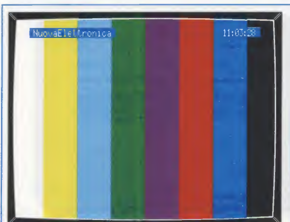
Fig.24 Questa è la prima delle 16 figure standard (pattern) che compaiono sul TV dopo averlo collegato al Generatore. Sulla figura appaiono l'ora e il logo prescelto.
