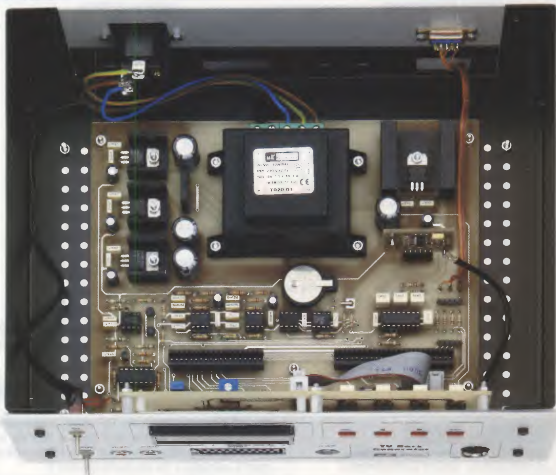
Fig.18 Foto del circuito stampato LX.1630 già fissato sul piano del mobile metallico. In questa foto si nota anche la piccola scheda premontata siglata KM.1632 inserita nel suo connettore con i componenti rivolti verso il pannello frontale e la Presa d'uscita RF.
