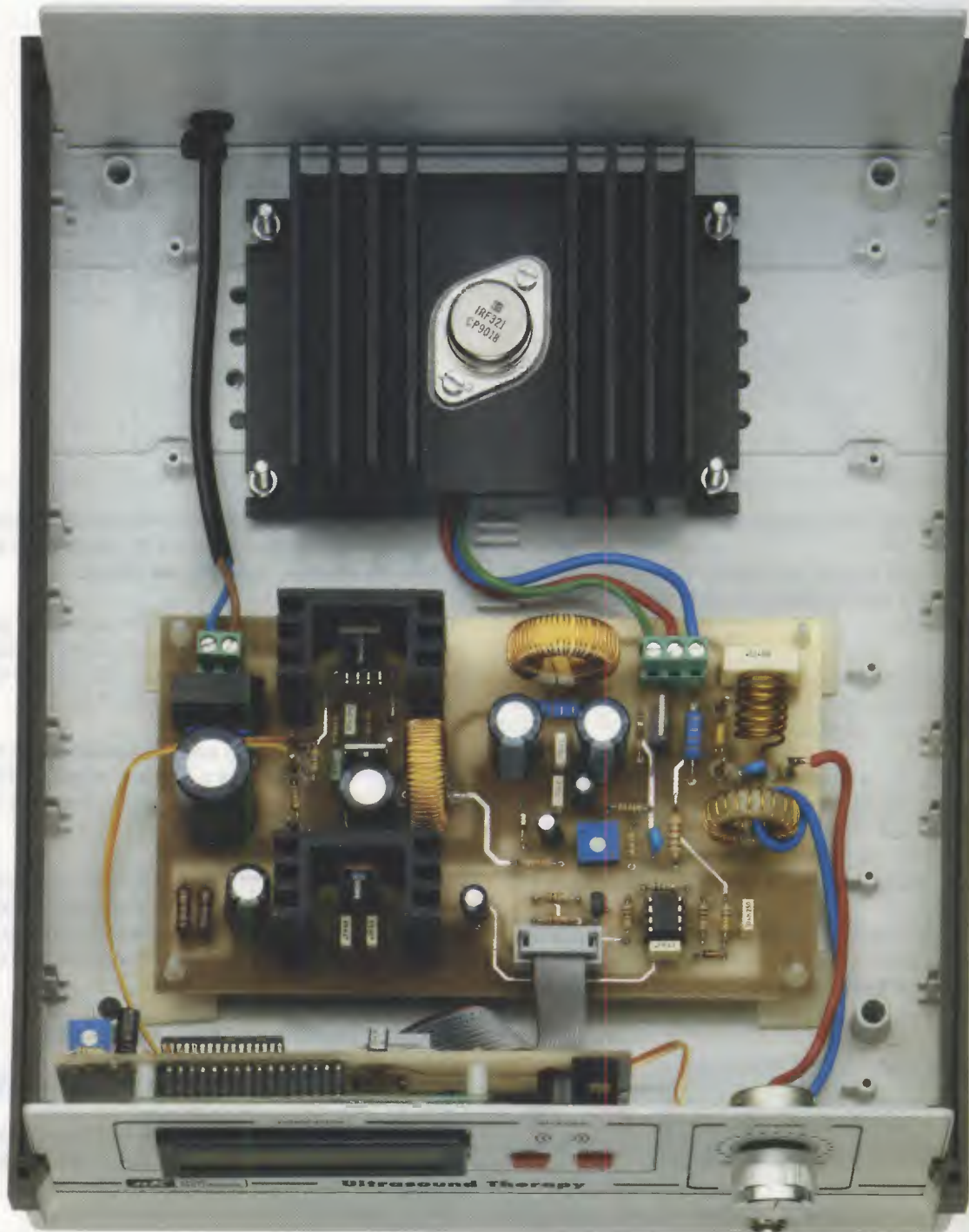
Fig.20 Ecco come si presenta il generatore di ultrasuoni una volta ultimato l'inserimento nel mobile. In alto è visibile l'aletta di raffreddamento del Mosfet di potenza IRF.321 e il cavo di collegamento all'alimentatore esterno, che dovrà essere fermato in corrispondenza del passacavo mediante una comune fascetta in plastica.
