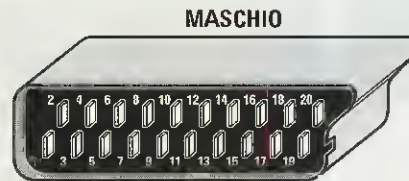
Fig.5 Connessioni della presa scart Maschio viste frontalmente. Il terminale 1 è il primo posto in basso a sinistra, mentre il terminale 19 è l'ultimo posto in basso sulla destra.
