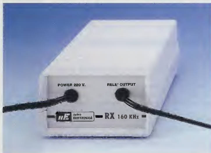
Fig.13 Foto del mobile dello stadio ricevente LX.1502 utilizzato per far eccitare o diseccitare il relè posto al suo interno (vedi fig.15).
