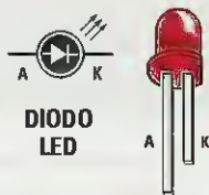
Fig.9 Questo disegno vi serve per sapere dove inserire i vari componenti sul circuito stampato LX.1500. Qui sotto le connessioni A-K dei diodi led.
