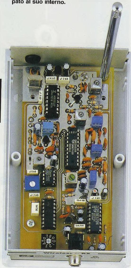
Fig.1 Sulla destra, come si presenta il mobile del ricevitore FM idoneo a captare le frequenze da 170 a 173 MHz. Qui sotto, il mobile al quale abbiamo tolto il coperchio per farvi vedere come abbiamo disposto il circuito stampato al suo interno.
