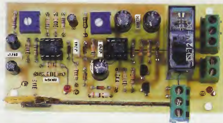
Fig.5 Schema pratico di montaggio del rilevatore di vibrazioni. Il dischetto della capsula piezoelettrica va infilato nella piccola asola posta vicino alla resistenza R3 e li saldato. Sulla superficie "bianca" del dischetto saldate un sottile filo di rame che vi servirà per prelevare il segnale BF.
