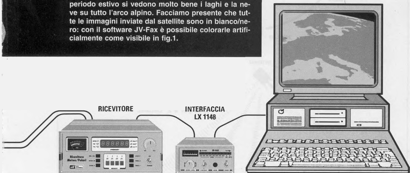
Fig.4 Il segnale prelevato dal Convertitore collegato alla parabola a Griglia viene inserito nel Ricevitore e applicato tramite un'Interfaccia ad un Computer provvisto di un sistema operativo MS-DOS. Se, oltre al Meteosat, si desiderano ricevere anche i satelliti Meteo Polari, occorre una antenna supplementare a doppio V completa di preamplificatore.
