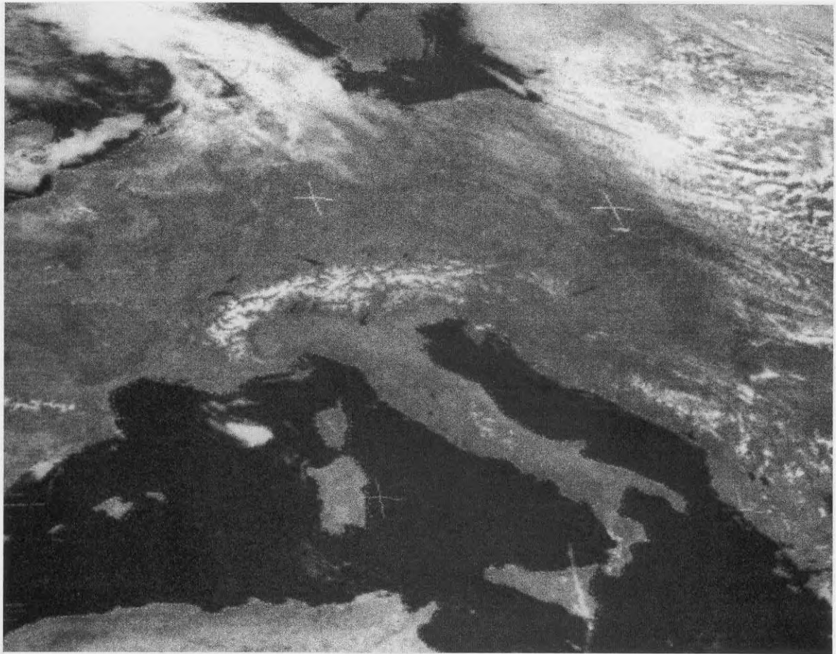
Fig.3 In questa immagine CO3 dell'Italia ripresa nel periodo estivo si vedono molto bene i laghi e la neve su tutto l'arco alpino. Facciamo presente che tutte le immagini inviate dal satellite sono in bianco/nero: con il software JV-Fax è possibile colorarle artificialmente come visibile in fig.1.
