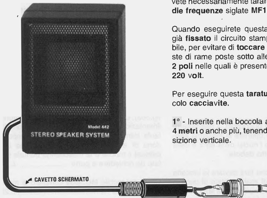
Fig.385 Dalla piccola Cassa Acustica, contenente l'altoparlante, fuoriesce un sottile cavetto schermato. Dopo aver spellato la sua estremità in modo da separare i due fili, dovete saldare quest'ultimi sui terminali del connettore jack maschio inserito nel kit. Arrotondate bene i sottili fili della calza di schermo per evitare che ne rimanga qualcuno volante.
