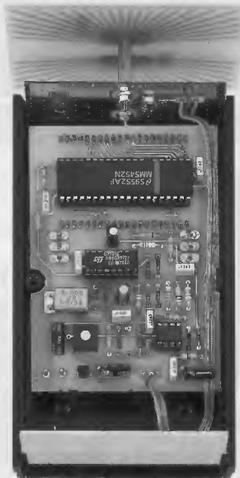
Fig.10 Il circuito stampato va bloccato all'interno del mobile con i dadi dei deviatori a levetta S1-S2. Se il modulo IC1 dovesse muoversi, potete fissarlo nella scanalatura con una goccia di collante.
