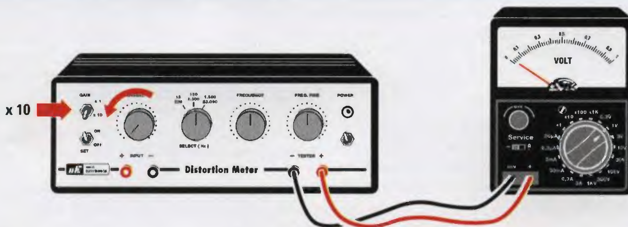
Fig.13 Prima di utilizzare il Misuratore di Distorsione dovete tarare il trimmer R28 per eliminare la tensione di offset presente sull'uscita di IC3/B. Dopo aver ruotato il potenziometro d'ingresso R1 al minimo ed aver spostato il deviatore S3 sulla posizione x10, ruotate il cursore del trimmer R28 fino a far deviare la lancetta del tester verso 0 volt.
