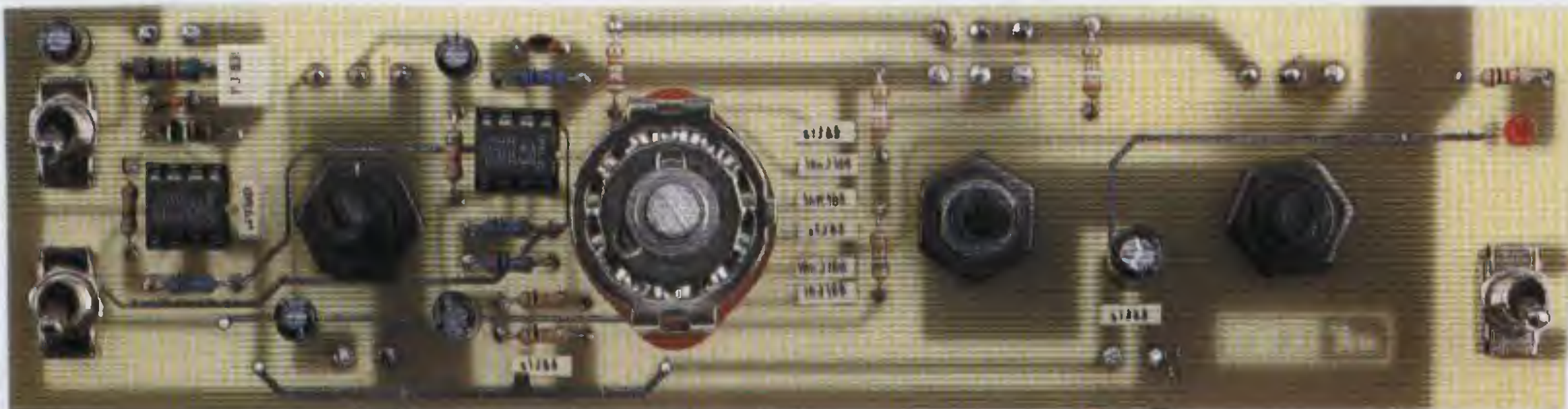
Fig.8 Come si presenta il circuito stampato LX.1392 a montaggio ultimato. Poiché questa è la foto di un prototipo mancano sia il disegno serigrafico sia la vernice protettiva.
