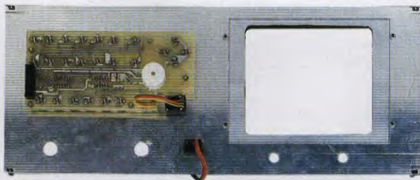
Fig.20 Montate il circuito della tastiera sul retro del pannello frontale usando dei distanziatori di metallo (vedi fig.22).
