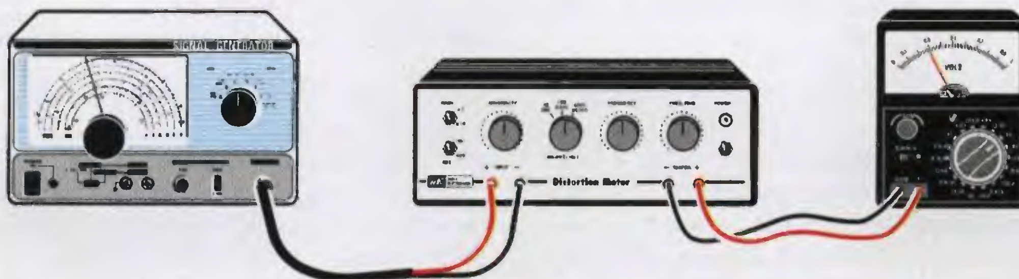
Fig.14 Prima di misurare la distorsione di uno stadio finale o di un preamplificatore dovrete collegare sull'ingresso il segnale fornito dal Generatore di BF e controllare il valore della sua distorsione, perché questa, sommandosi alla distorsione dell'apparato sotto esame, andrà sottratta come spiegato nell'esempio descritto nel testo.
