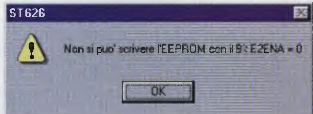
Fig.28 Il simulatore ha rilevato un'altra istruzione formalmente corretta, ma logicamente errata: non è possibile scrivere nella EEPROM se il bit 2 è uguale a zero.
