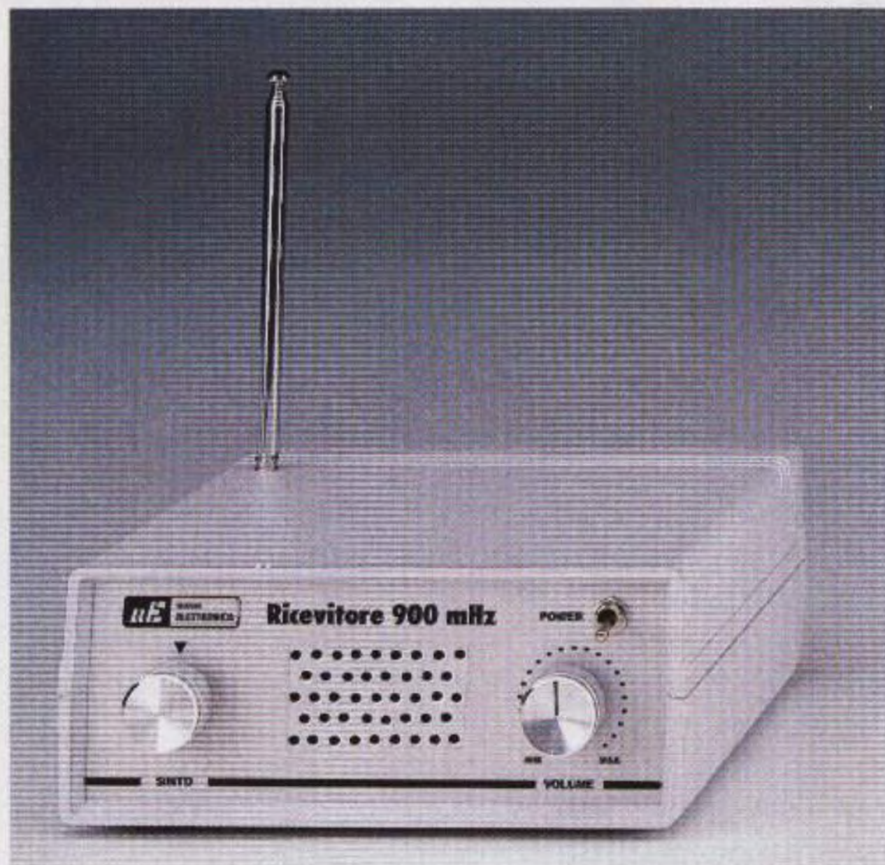
Fig.1 Per captare i segnali dei ponti radio e dei telefoni cellulari o si acquista un Analizzatore di Spettro o si realizza questo semplice ricevitore che permette di ascoltare anche l'audio. Questo ricevitore può essere alimentato con una tensione di 12 volt che si può prelevare dalla batteria di un'auto oppure da un piccolo alimentatore in grado di erogare 12 volt.
