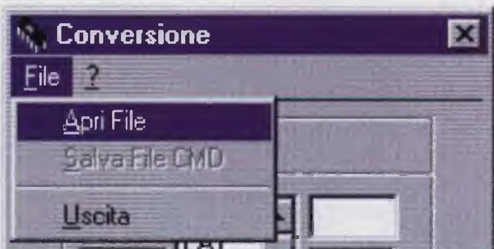
Fig.30 Per aprire un file .DAT, che contiene i segnali in uscita ottenuti durante una simulazione, cliccate sul menu File e scegliete Apri File.
