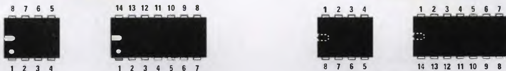
Fig.105 La tacca di riferimento a forma di U presente sul corpo dell'integrato ci permette di individuare il piedino 1. In sostituzione di questa U possiamo trovare un piccolo "punto" in prossimità del piedino 1. Sulla sinistra, la disposizione dei piedini osservando l'integrato da sopra e, a destra, la disposizione dei piedini osservandolo da sotto.
