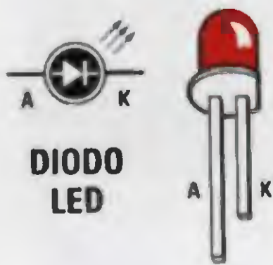
Fig.3 Le connessioni dei due integrati sono viste da sopra. Il terminale più lungo dei diodi led è l'A.
