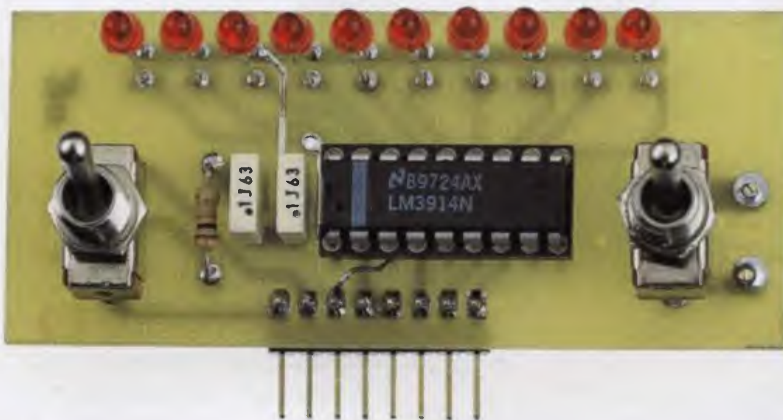
Fig.7 Foto ingrandita dello stadio LX.1368/B. Il terminale più "corto K" dei diodi led va rivolto verso l'integrato IC2. Prima di saldarne i terminali sulle piste del circuito stampato, dovete verificare se la loro testa fuoriesce dai fori presenti sul pannello frontale come appare evidenziato nella foto riprodotta qui sotto.
