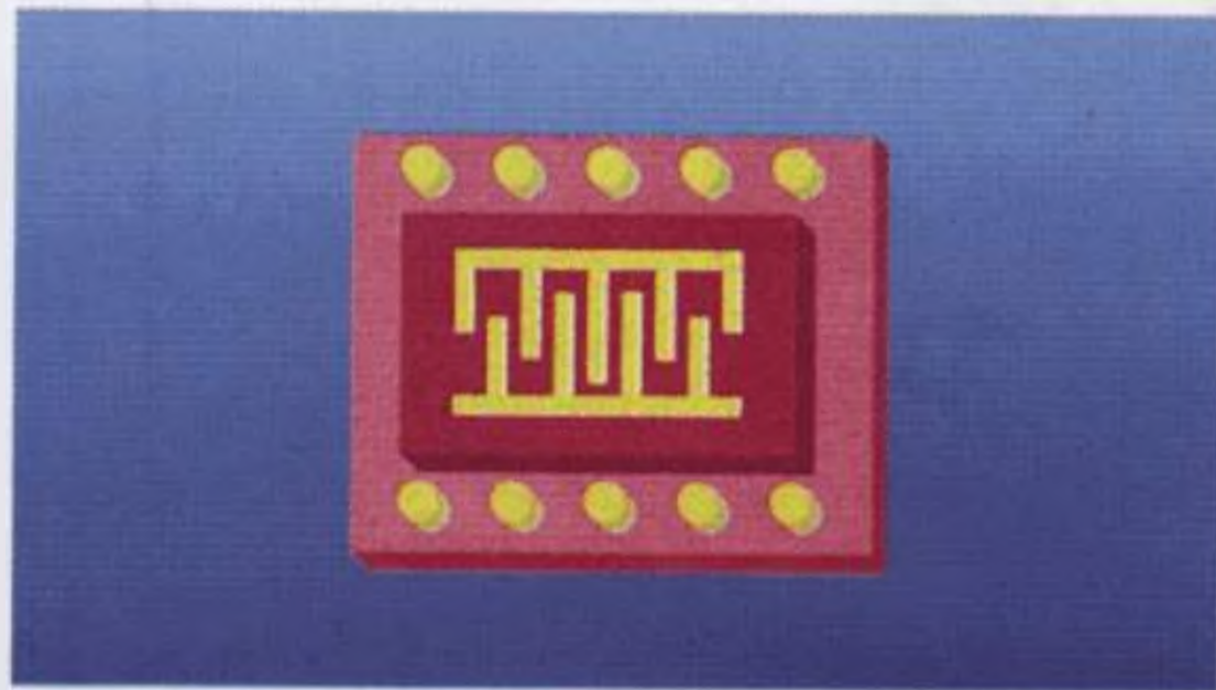
Fig.1 Chip di un risuonatore SAW visto al microscopio. All'interno dei risuonatori SAW non è presente alcun cristallo di quarzo che, entrando in risonanza, generi una frequenza, ma delle piste disposte a pettine depositate sopra uno speciale materiale piezoelettrico.
