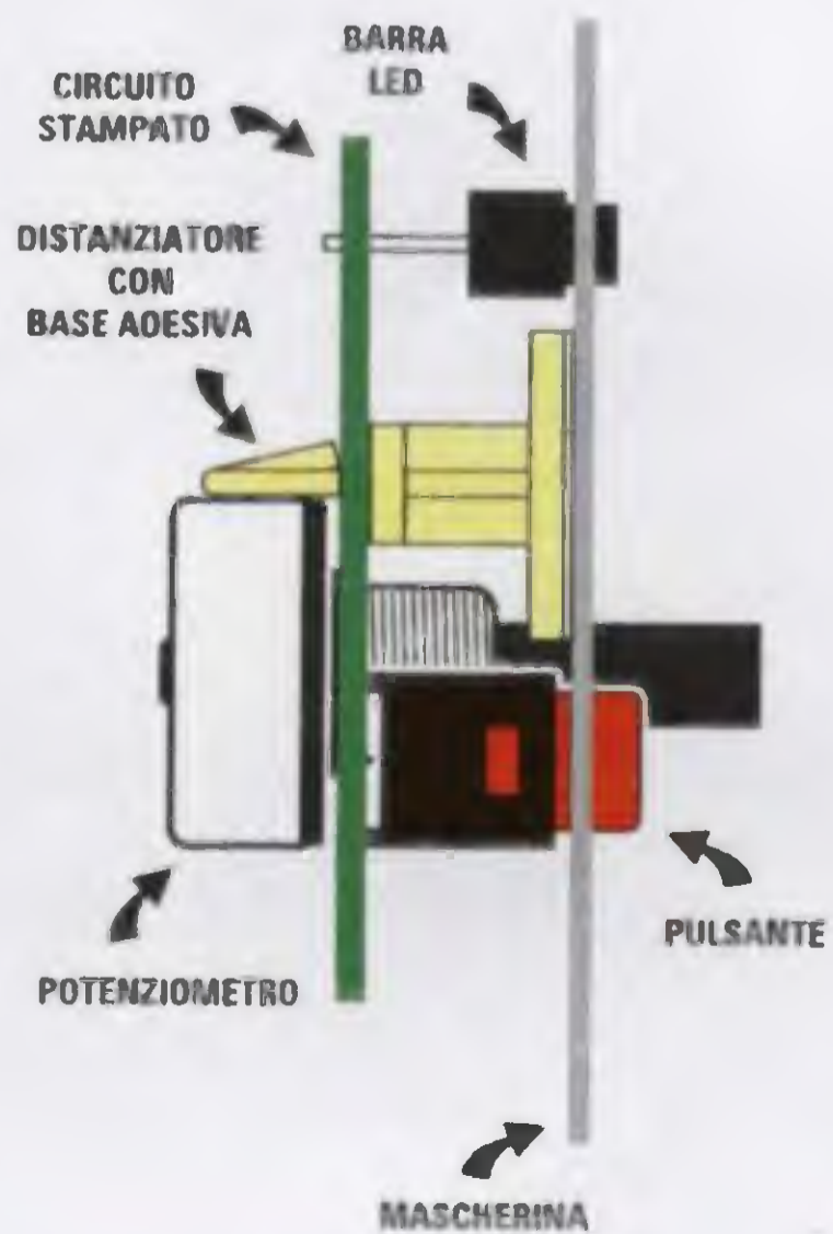
Fig.4 Schema pratico di montaggio della scheda della pulsantiera e dei diodi led, siglata LX.1365/B, vista da entrambi i lati. L'asola di riferimento del CONN.1 va rivolta verso l'integrato IC4. Questo circuito viene fissato sul pannello frontale con tre distanziatori plastici con base autoadesiva.
