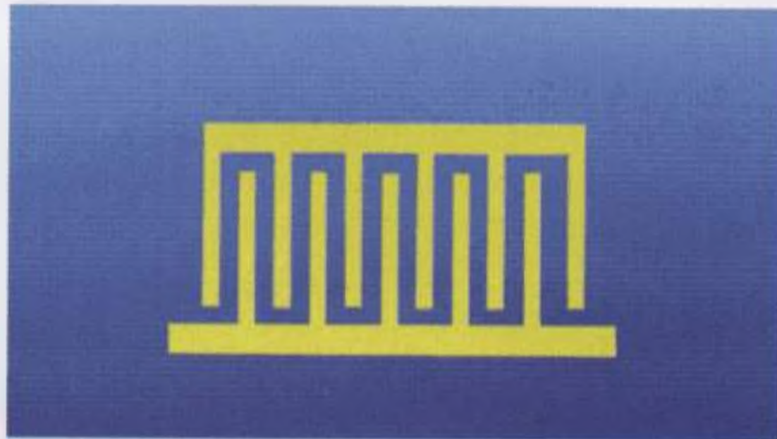
Fig.2 Il numero delle piste, la loro spaziatura e la loro lunghezza determina la frequenza di risonanza. Questi risuonatori sono molto stabili in frequenza ed inoltre molto precisi e per questi motivi vengono montati in molti radiocomandi ed anche su diversi radiomicrofoni in UHF.
