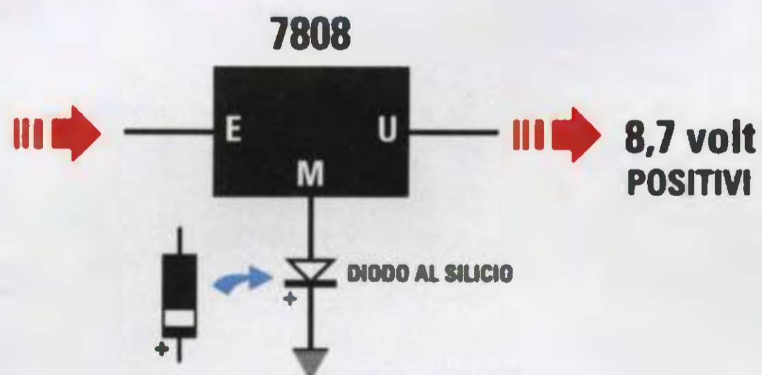
Fig.39 Se prendiamo un integrato uA.7808 che fornisce in uscita 8 volt Positivi e colleghiamo tra il terminale M e la massa un diodo al silicio, rivolgendolo il suo terminale + verso massa, sull'uscita preleveremo una tensione stabilizzata di 8,7 volt.
