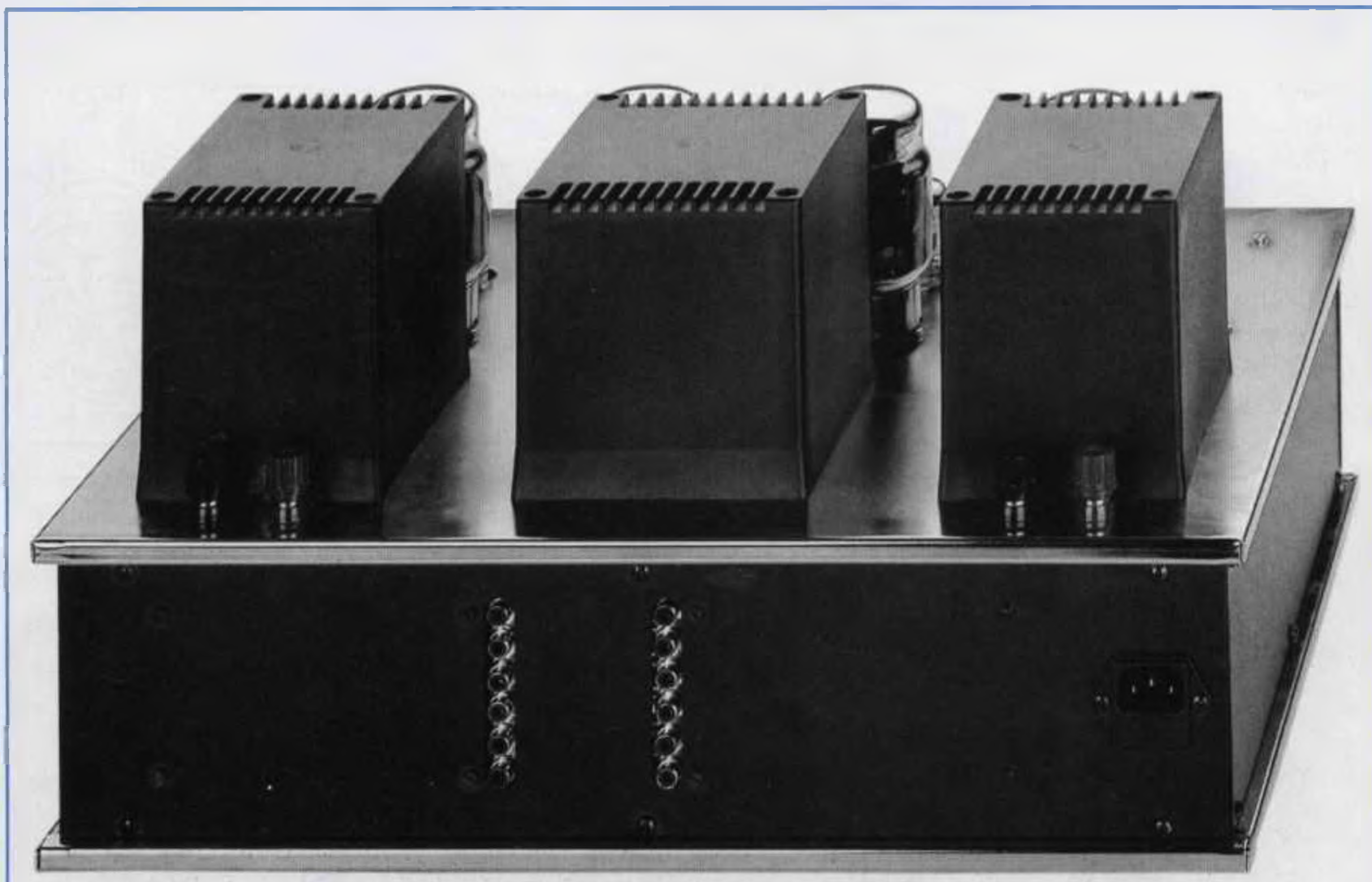
Fig.17 Sul retro del pannello appaiono tutte le prese d'ingresso. Anche se in questa foto non appare, in corrispondenza di ogni boccola risulta riportata l'indicazione di ogni singolo ingresso. Dietro ai trasformatori d'uscita sono presenti le due morsettiere per il collegamento con le Casse Acustiche. Facciamo presente che i due piani superiore e inferiore del mobile sono CROMATI LUCIDI, mentre i laterali verniciati in Nero opaco.
