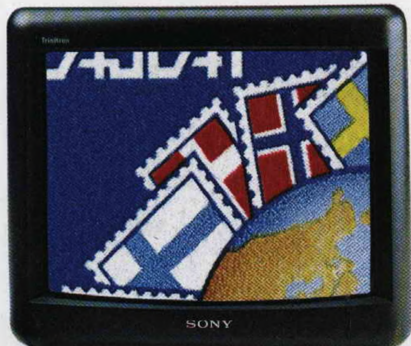
Fig.9 Avvicinando il francobollo a soli 0,5 centimetri dall'obiettivo e' possibile aumentare gli ingrandimenti. Per illuminare tutti i soggetti posti sotto all'obiettivo conviene usare la luce emessa da una lampada a filamento, perchè quella emessa da un neon falsa i colori.
