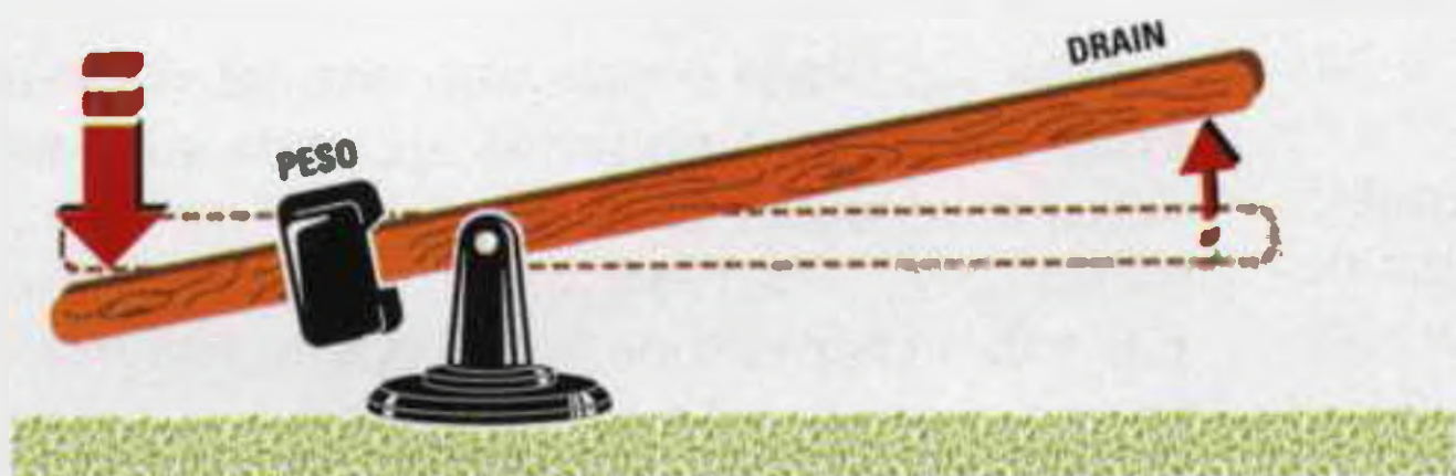
Fig.483 Se dalla posizione orizzontale spingeremo verso il basso il Gate la parte opposta di Drain si solleverà. L'onda sinusoidale che applicheremo sul Gate sposterà questa leva in alto o in basso.
