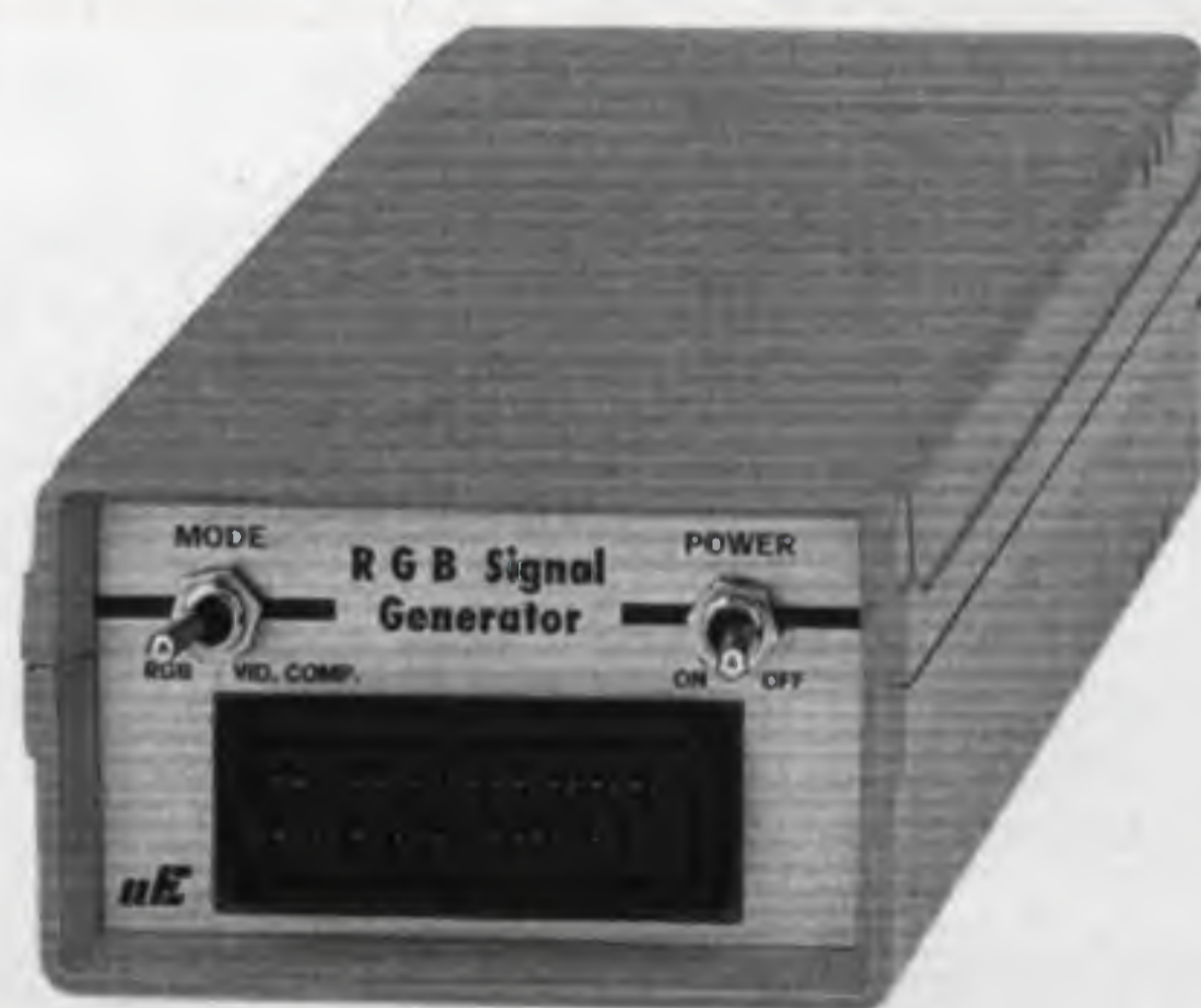
Fig.2 Tutto il circuito andrà racchiuso in un mobile plastico completo di un piccolo vano atto a contenere una pila da 9 volt.
