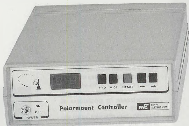
Fig.1 I due pulsanti di sinistra presenti sul pannello vi serviranno per impostare la posizione in cui la parabola dovrà direzionarsi. Il pulsante di Start serve per far partire il motorino ed i due pulsanti di destra per spostare di pochi millimetri la parabola verso destra o verso sinistra.
