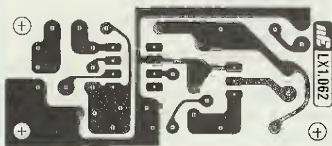
Fig.4 Disegno a grandezza naturale del circuito stampato visto dal lato rame.
