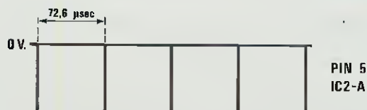
Fig.2 Dal piedino d'uscita 5 dell'integrato siglato IC2/A utilizzato come oscillatore astabile (vedi fig.6), usciranno degli impulsi negativi strettissimi, che andranno utilizzati per pilotare il piedino 8 del monostabile siglato IC2/B. Questi due integrati sono contenuti all'interno di un NE.556.
