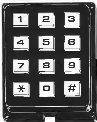
Fig.5 Sulla tastiera, oltre ai numeri da 0 a 9, è presente il tasto *, per eseguire le SOTTRAZIONI ed il tasto # per le SOMME. Sul retro della tastiera sono presenti 8 terminali (disegno a destra), che andranno collegati al circuito con uno spezzone di pattina ed un connettore femmina (vedi fig.9).
