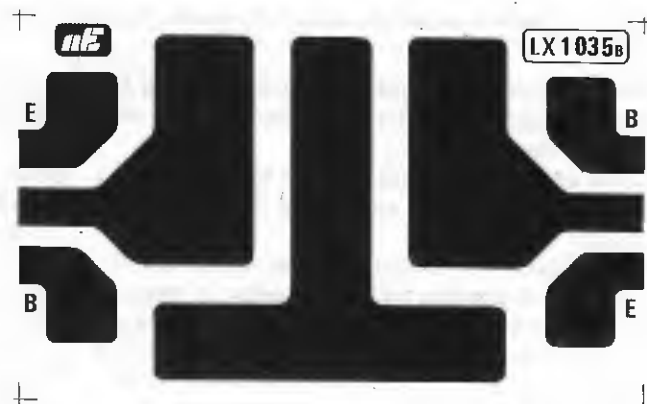
Fig. 6 Disegno a grandezza naturale, visto dal lato rame, del circuito LX. 1035/B. Come visibile in fig. 8, tutti i componenti andranno direttamente saldati sul lato rame.
