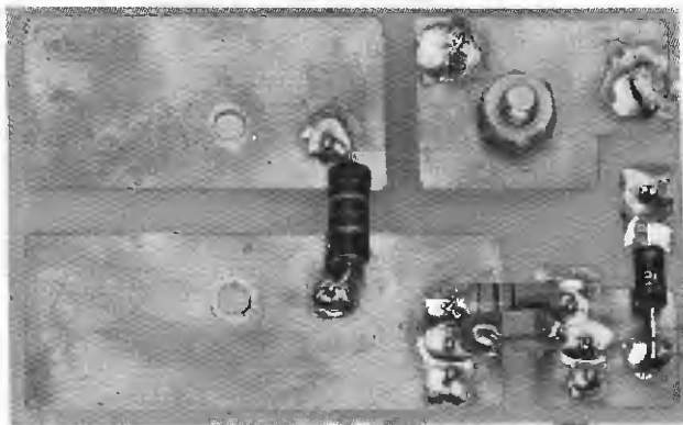
Fig.12 Foto ridotta della basetta siglata LX.1033/B vista dal lato rame, con sopra già saldati tutti i componenti richiesti.
