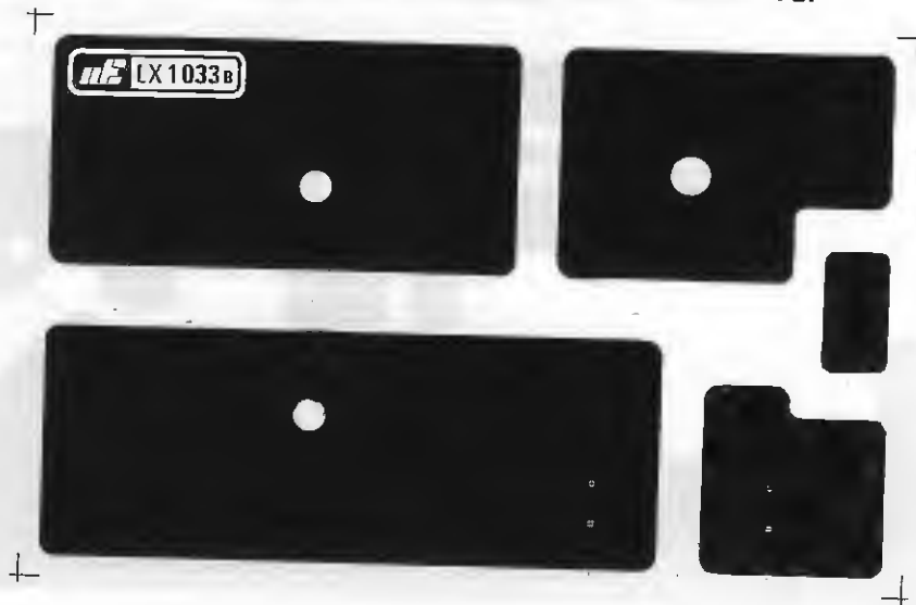
Fig.11 Disegno a grandezza naturale dello stampato LX.1033/B visto dal lato rame. Il rame depositato su questo supporto in vetronite ha uno spessore superiore rispetto ai normali stampati per uso standard.
