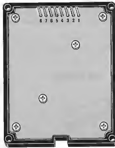
Fig.5 Sulla tastiera, oltre ai numeri da 0 a 9, è presente il tasto *, per eseguire le SOTTRAZIONI ed il tasto # per le SOMME. Sul retro della tastiera sono presenti 8 terminali (disegno a destra), che andranno collegati al circuito con uno spezzone di pattina ed un connettore femmina (vedi fig.9).
