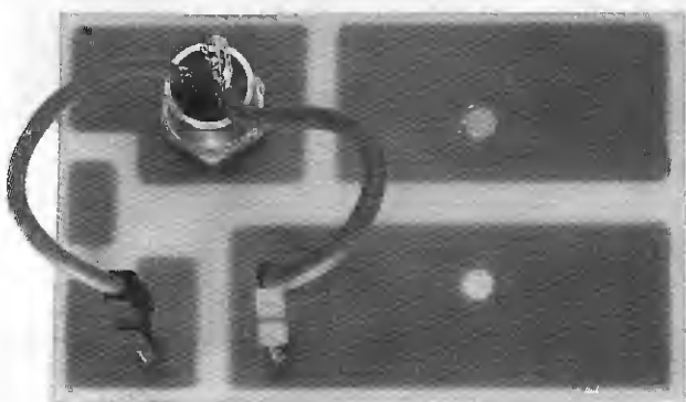
Fig.13 Dal lato opposto di questo stampato troverete i due terminali del diodo SCR, che dovrete fissare sulle due piste Gate - Catodo come visibile in fig.14.
