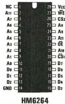
Fig. 1 Schema elettrico della memoria e connessioni degli integrati visti dall'alto.
