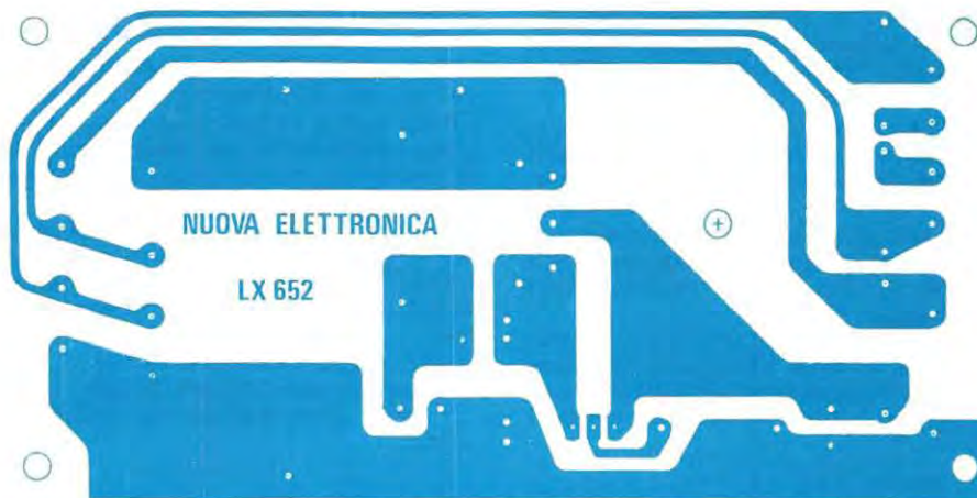
Fig. 7 Disegno a grandezza naturale del circuito stampato richiesto per la realizzazione dello schema di fig. 5.
