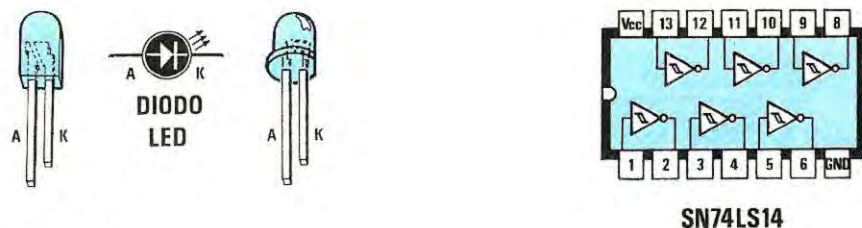
Fig. 2 Le connessioni viste da sopra dell'integrato 74LS14 e dei terminali dei diodi led. Si noti come il terminale Anodo sia piu' lungo del Catodo. Qui sotto, ecco come si presenta la scatola in plastica sulla quale anteriormente è già fissato il connettore femmina da innestare nel computer.
