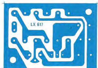
Fig. 2 Disegno a grandezza naturale del circuito stampato
