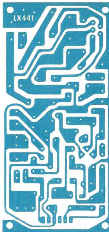
Fig. 5 Queste sono le dimensioni reali del circuito stampato necessario a realizzare questo ricevitore in superreazione. Il circuito viene fornito già forato e completo di disegno serigrafico dei componenti.
