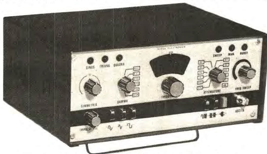
Nella foto, come si presenta a realizzazione ultimata questo generatore di funzioni.
