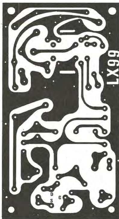
Fig. 5 Disegno a grandezza naturale del circuito stampato LX 99 utile per l'amplificatore con il TBA.800.
