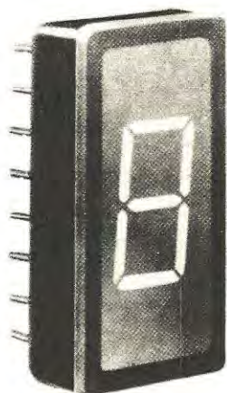
Foto di un display a filamento ingrandito di circa due volte. In questo display ogni segmento è costituito da un sottilissimo filamento rettilineo che si accende se alimentato da una tensione di 5-7 volt.
