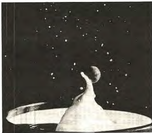
Fig. 6 Con questo stroboscopio possiamo ottenere dai 15 ai 200 lampi al secondo il che significa fotografare in un secondo 15-200 volte l'oggetto in movimento. In questa foto abbiamo colto una sfera nell'istante in cui sta cadendo in un bicchiere di latte e contemporaneamente lo spruzzo del latte quando la sfera si è già immersa.
