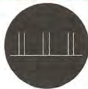
Fig. 9 Impulsi presenti sul primario di T1 in assenza di segnale visti all'oscilloscopio.
