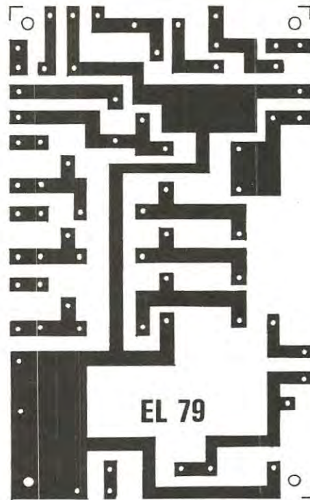
Fig. 5 Circuito stampato a grandezza naturale del provadiodi presentato in articolo.
