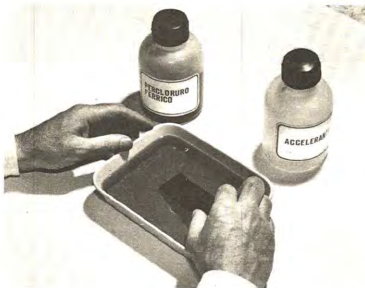
Fig. 8 - La lastra già protetta con l'apposito inchiostro, potrà poi essere immersa nella bacinella. Per accelerare e favorire l'incisione la lastra andrà immersa con la parte del rame sempre rivolta verso il basso.
