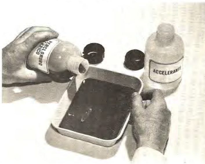
Fig. 7 - In una bacinella di plastica versate ora la soluzione concentrata di percloruro ferrico e di accelerante. Come già precisato nell'articolo la proporzione dei due liquidi non influisce sulla buona riuscita, quindi si può variare senza alcun inconveniente.
