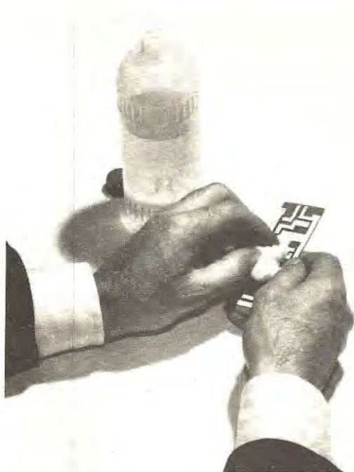
Fig. 10 - Quando il circuito risulterà perfettamente inciso, per asportare l'inchiostro protettivo dalla superficie del rame, sarà sufficiente strofinare sopra ad esso un batuffolo di cotone imbevuto di normale alcool denaturato.
