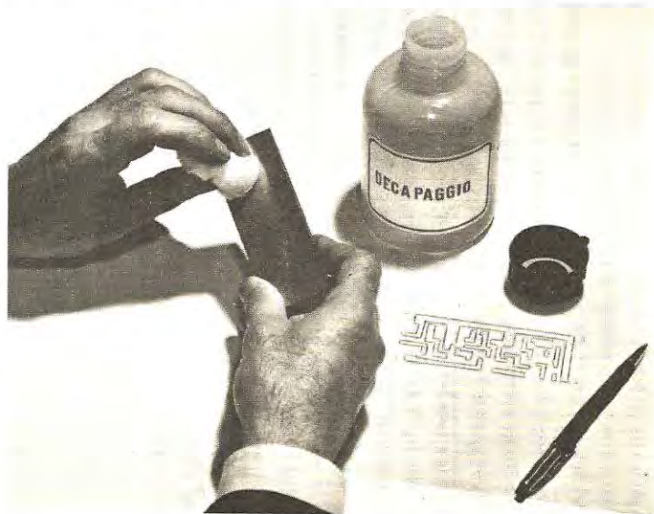
Fig. 3 - Per togliere le ineliminabili tracce di ossido o di grassi presenti sulla lastra di rame, pulitene la superficie strofinando sopra ad essa un batuffolo di cotone imbevuto con soluzione di decapaggio.
