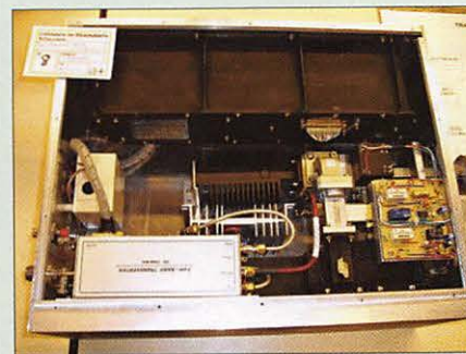
5 - Transverter 70/3 cm, 50 W HF, par F5BUU.
