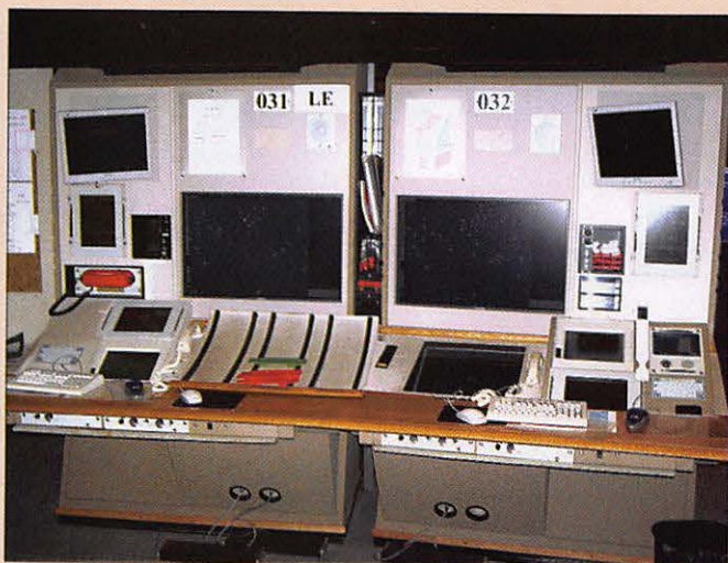
6 - Pupitres d'un contrôleur aérien du secteur LE (Lyon-Est) de la FIR Marseille: un écran principal, d'autres de commande ou d'information; les supports rouges et verts sont destinés à recevoir le "strip", la fiche de chaque avion avec son immatriculation, son N° de vol, sa route, etc.) La couleur du support a une importance: rouge la route est vers le nord, vert vers le sud. Au sol les pédales de commande d'émission radio.
