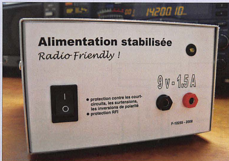
L'alimentation "propre", ne générant pas d'interférences radioélectriques.
