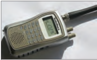
3 - Le scanner RADIO SHACK PRO-83. Petit, pas cher, très sensible, il est équipé du système "Radio Stalker" de mesure directe de fréquence d'un émetteur proche.
