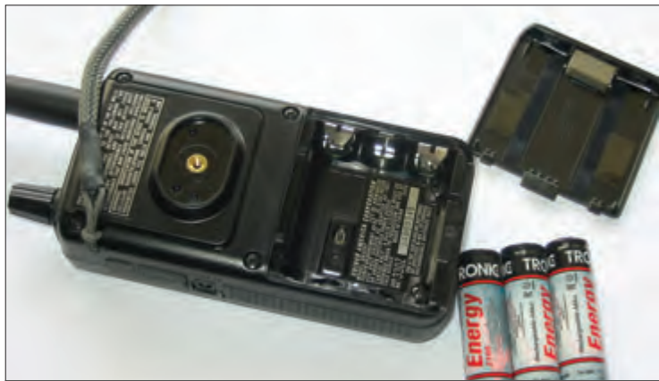
9 - Le scanner UNIDEN BR330T est alimenté par 3 accumulateurs NiMH.
