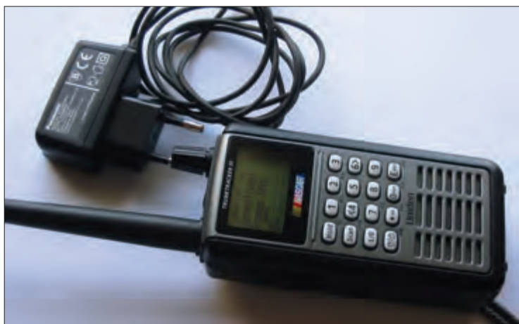
10 - Le scanner UNIDEN BR 330T avec une alimentation à découpage 6 V - 800 mA.
