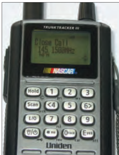
8 - Dès qu'une source proche est détectée, la fréquence reçue est affichée en appuyant sur une touche.
