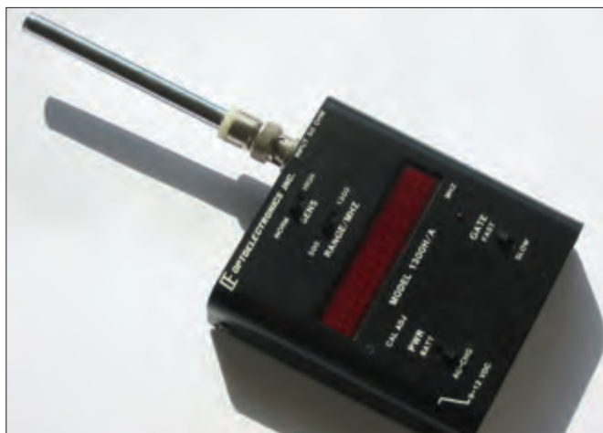
1 - Un des premiers fréquencemètres OPTOELECTRONICS conçu pour la mesure directe de la fréquence reçue, avec un affichage à LED. L'entrée 50 ohms permet la mesure directe sur une antenne.
