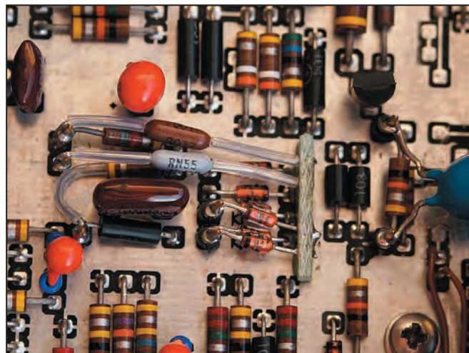
9 - Vue d'une modification SB pratiquée par Collins.
