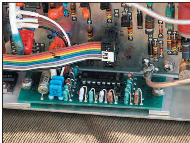
5 - La modification du filtre passe-bas CW.
