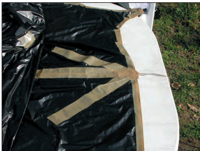
2 - Fixation des suspentes de la charge utile.
