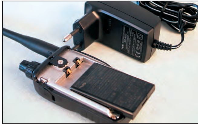
2 - La batterie, très plate, de 1 000 mAh et le chargeur fourni.
