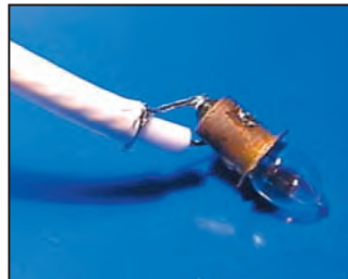
Figure 11: Branchement du câble coaxial sur la charge.
