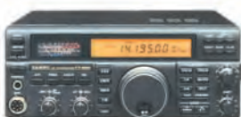
FT-840 Emetteur/récepteur HF base/mobile 100 W
