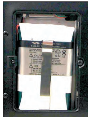
Installation de la batterie.
