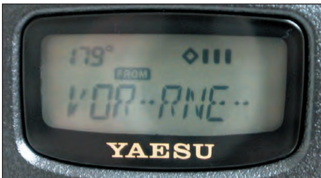
En mode NAV, affichage de la radiale VOR et de l'écart de route.
