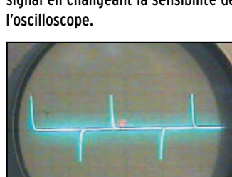
Photo 12 : R=22 ohms. Des belles impulsions très fines.
