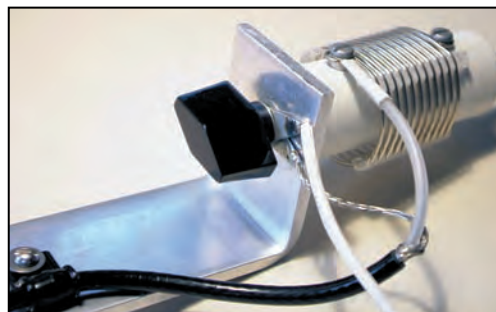
Montage du câble et du contrepooids.
