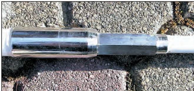
La jointure entre deux brins.
