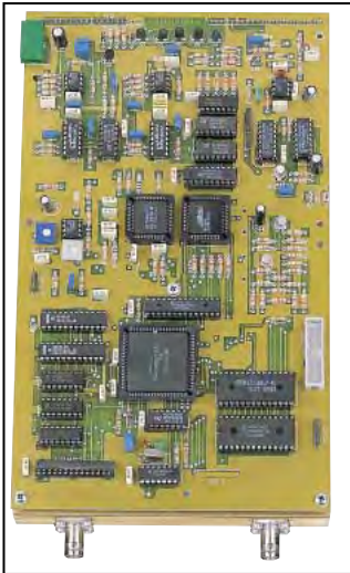
Carte digitale déjà fixée sur bloc en aluminium fournie entièrement montée et calibrée. Les trimmers présents sur cette carte ne doivent pas être déréglés.
