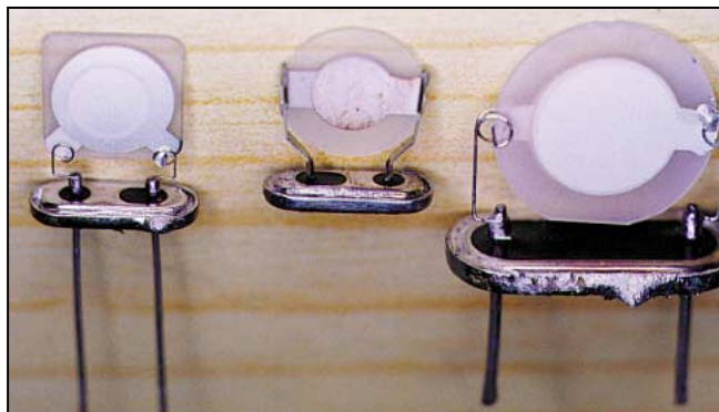
Figure 3 - Quartz dépourvus de leur boîtier de protection.
