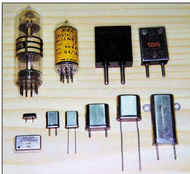
Figure 2 - Divers types de boîtiers de quartz.
