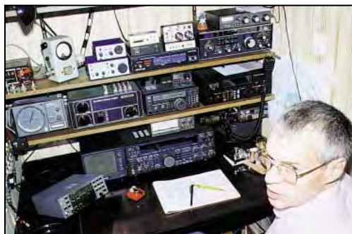
Une station "classique" n'empêche pas le QRP : En haut le "Norcal" et le "Sierra", plus bas le "K2" à côté du carnet de trafic.
