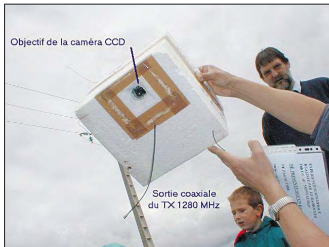
Vue du fond de la nacelle, montrant la fenêtre de la caméra, ainsi que le câble de l'antenne 1280 MHz.
