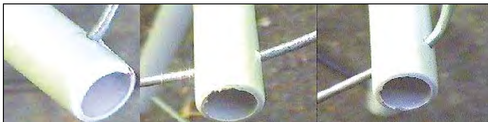
Figure 9 : Détails du passage des fils des spires à travers les tubes PVC respectivement en haut, en bas et au milieu de l'antenne.
