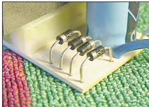
Photo 1 - Quatre diodes pour redresser le courant.
