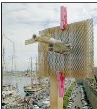
Antenne panneau 1,2 GHz, conception F1CCP.
