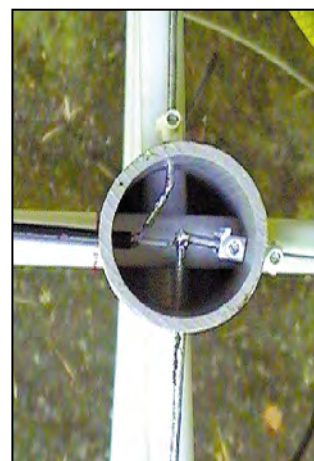
Figure 7 : Connexions du haut de l'antenne (vue de dessus). La moitié de la grande boucle est obligatoirement réalisée en coax. Les trois autres brins peuvent être en coax court-circuité ou en fil métallique.
