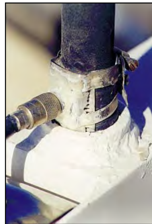
La base du fouet montrant le morceau de collier inox assurant la mise à la masse de la fiche.
