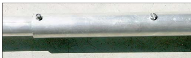
▲ Le gamma-match. ▼ Deux points de fixation c'est mieux qu'un seul !
