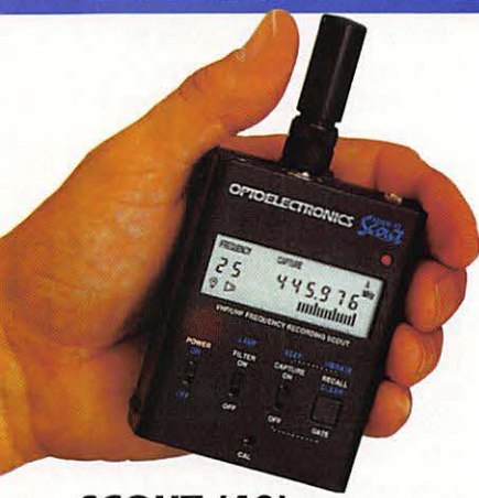
SCOUT (40) Fréquence portable. 400 mémoires. 10 MHz à 1,4 GHz
