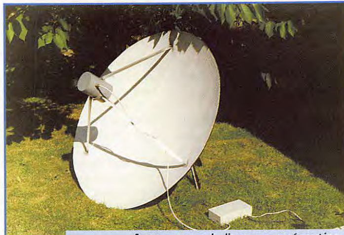
Antenne parabolique pour réception METEOSAT (1691 MHz).
