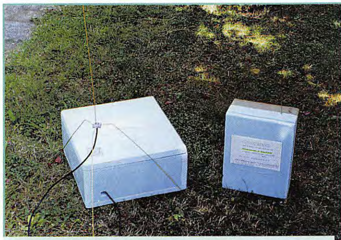
A gauche : la nacelle contenant le GPS et l'électronique du ballon n°2. L'antenne GP est séparée de la nacelle de façon à éviter les perturbations sur le GPS. A droite : la nacelle du ballon n°1.
