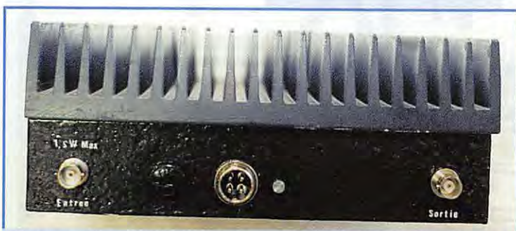
Face arrière du PA. 2 connecteurs BNC entrée/sortie HF, l'embase du connecteur 24 V et le porte-fusible.
