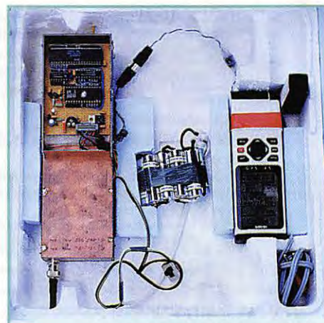
La nacelle du ballon n°2 (le boîtier du microcontrôleur a été ouvert pour la photo). Le GPS "GARMIN 45" est alimenté par ses propres piles.
