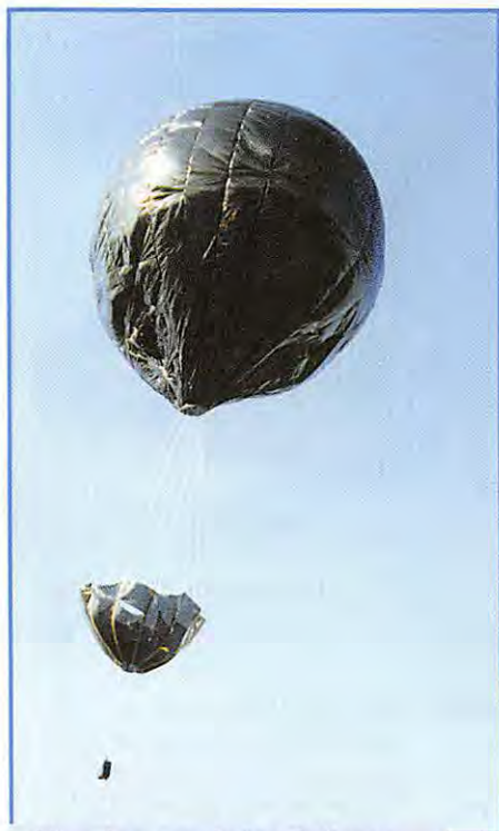
Non, le parachute n'est pas à l'envers ! Son rôle est de ralentir la montée...
