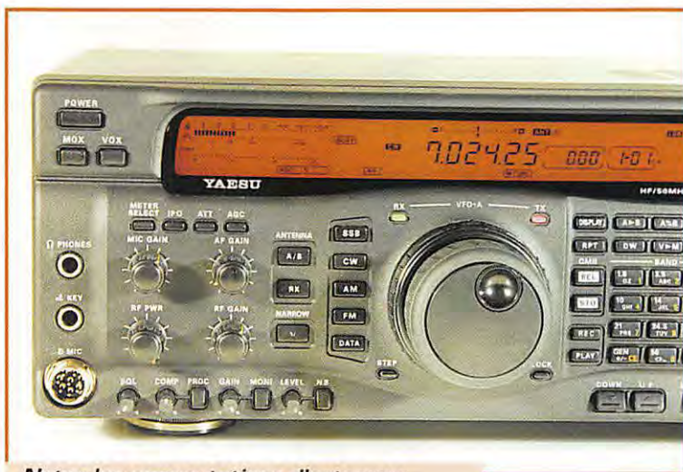
Notez les commutations d'antennes et des filtres étroits.
